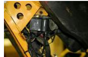
RETIRER LA BOBINE HAUTE TENSION EN DEBRANCHANT TOUS LES CABLES.
