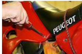
DEPOSE DU FLAN DE CARENAGE DROIT.
